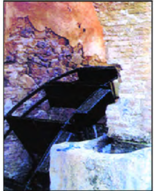
(١٢٩) من الحيل رفع الماء بالدولاب ذو المغارف. لاحظ تفريغ الماء في حوض صغير.
